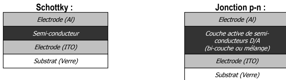
Figure 10 : Architecture des cellules solaires de type Schottky, et jonction p-n.
